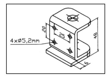
Die Winkel können, entsprechend ihrer Gewindeaufnahme, mit jeder Stellschraube mit 50 mm Mindestlänge montiert werden.
