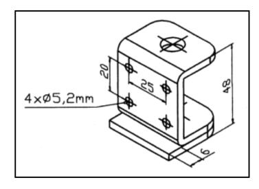
Die Winkel können, entsprechend ihrer Gewindeaufnahme, mit jeder Stellschraube mit 50 mm Mindestlänge montiert werden.
